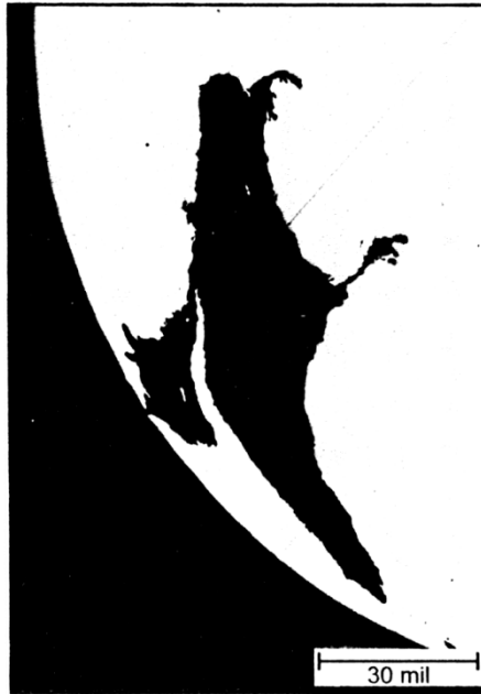
شکل ۳۹- سرباره حبس شده در مقطع میلگرد
