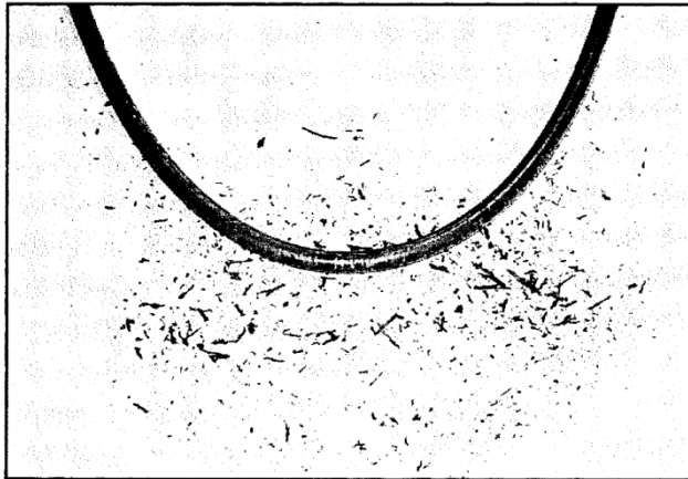
شکل ۱- پوسته ریخته شده میلگرد فولادی در حین خمش
